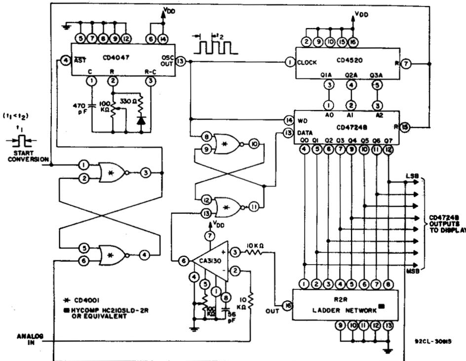
Fig. 5— A/D converter
